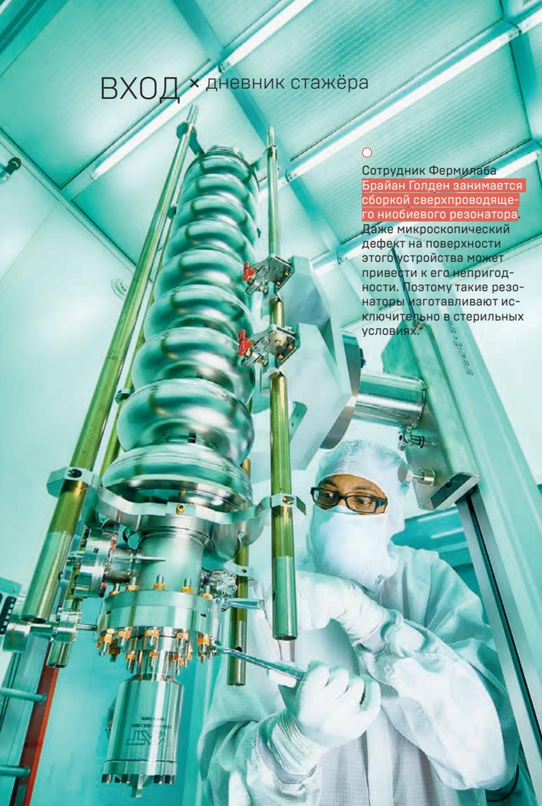
○ Сотрудник Фермилаба Брайан Голден занимается сборкой сверхпроводящего ниобиевого резонатора. Даже микроскопический дефект на поверхности этого устройства может привести к его непригодности. Поэтому такие резонаторы изготавливают исключительно в стерильных условиях.
