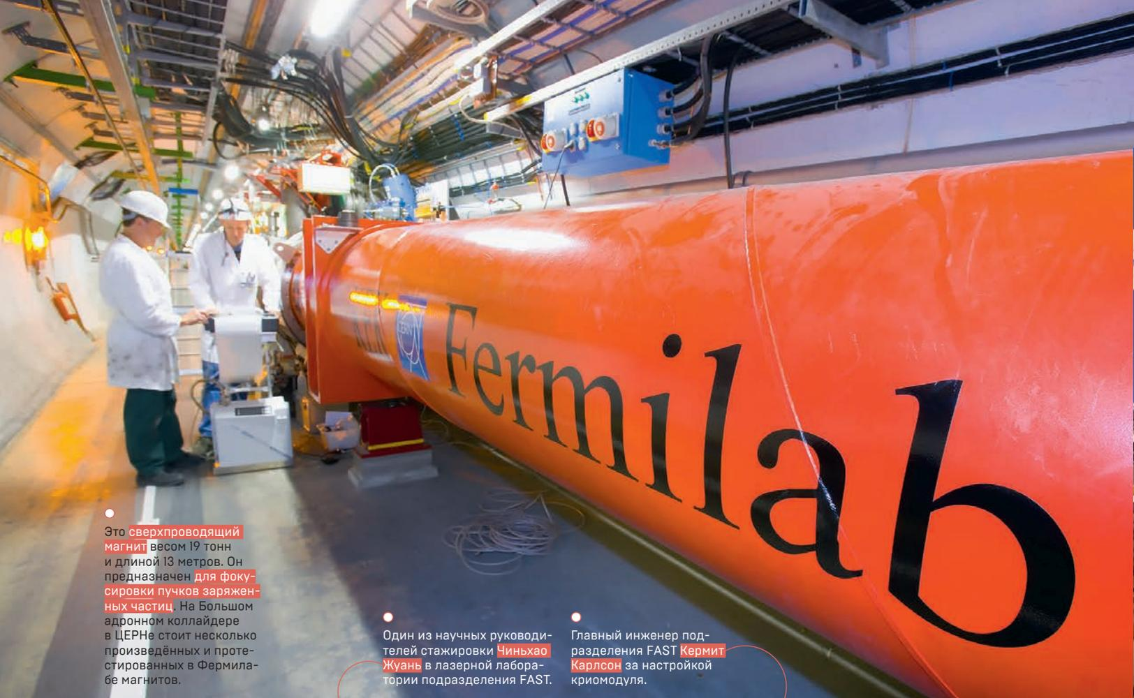
• Это сверхпроводящий магнит весом 19 тонн и длиной 13 метров. Он предназначен для фокусировки пучков заряженных частиц. На Большом адронном коллайдере в ЦЕРНе стоит несколько произведённых и протестированных в Фермилабе магнитов.
